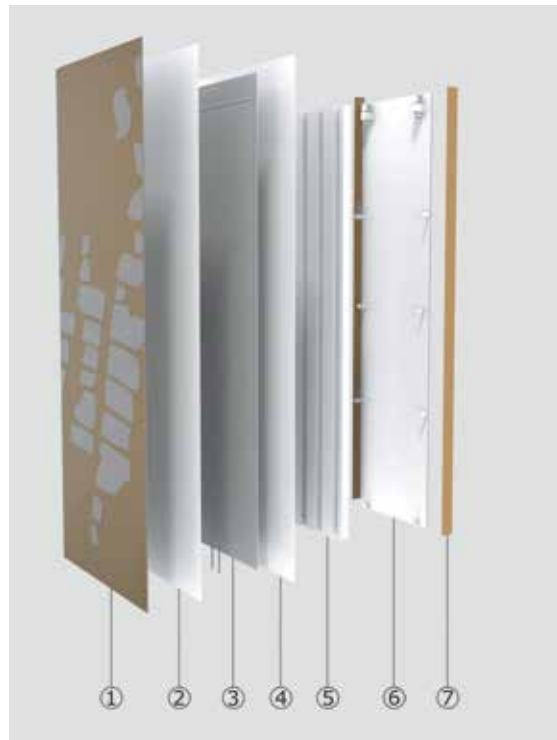
1 FINITION AVANT 2 COMPOSANT POLYMÈRE 3 PLAQUE DE TUBES CAPILLAIRES 4 COMPOSANT POLYMÈRE 5 STRUCTURE SUPPORT 6 PLAQUE DE FIXATION RÉFRACTAIRE 7 CACHES LATÉRAUX
